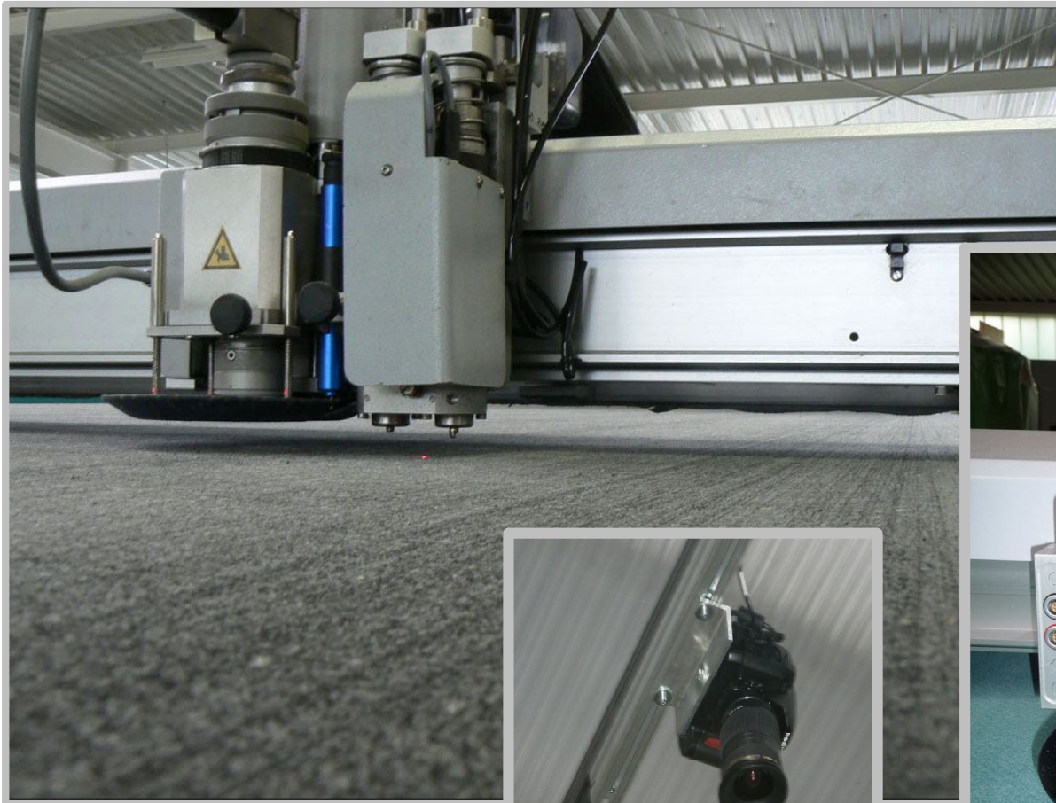
... Schneideeinheit und kameragestütztes Nesting
